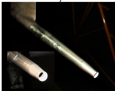
Pitotova trubice z letounu F/A-18 Hornet
